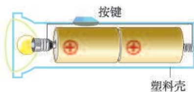
图 15.2-10 常用电筒的结构
