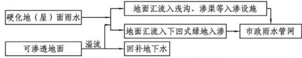
图A9-3 地面入渗系统的构成
