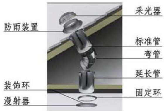
图E5-1 导光管结构示意图
