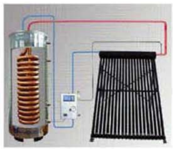
图F3-10 太阳能热水系统示意
