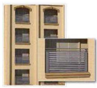
图F3-9 太阳能热水集热板立面效果
