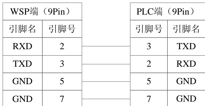
图 5.6 WSP-LG-CAB 连线
