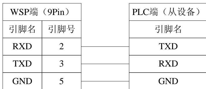
图 5.8 WSP 与 MODBUS 协议的 RS232 连接图
