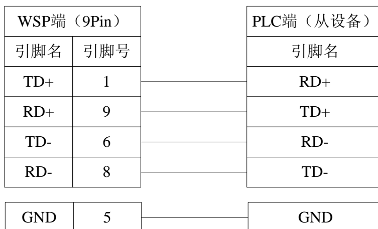
图 5.9 WSP 与 MODBUS 协议的 RS422 连接图
